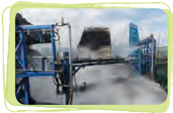
破碎站防風抑塵網和干霧抑塵裝置
