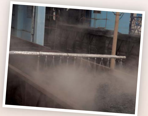
装车站喷洒环保封尘固化剂
